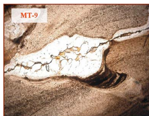
24. ábra: Az MT-9 nyersanyagminta mikroszkópos felvétele (1N). Erdőbénye. Az üregeket kitöltő kvarcsezemcsék többgenerációs kiválás eredményei
