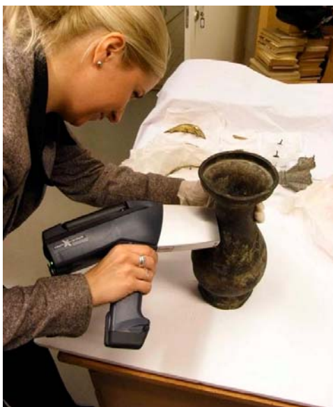
5. ábra: A bronzváza díszítő elemeinek kézi XRF készülékes vizsgálata (Jakab A. vizsgálata, Greenlab Kft. )
