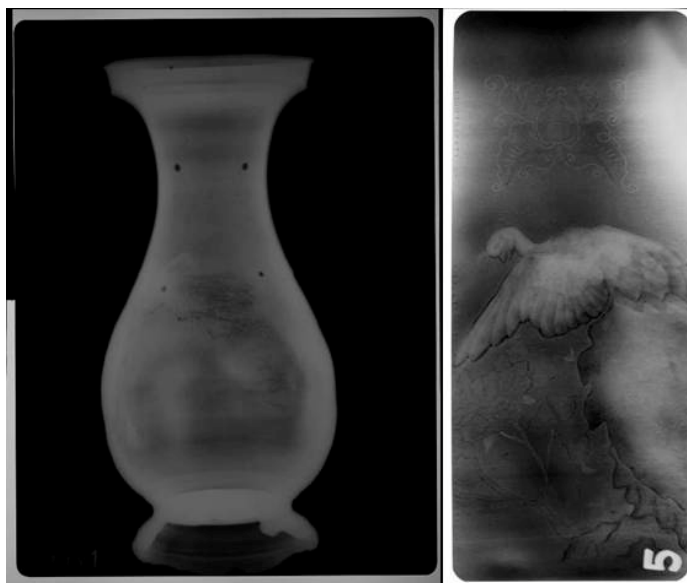
6. ábra: Japán bronzváza, 19. század, (Vasvári Pál Múzeum, Tiszavasvári). Hagyományos röntgen felvétel a váza szerkezetéről és fémberakásiról (Röntgen felvétel: Hutai G., MNM)
