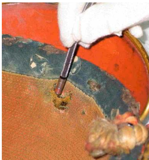
8. ábra: Előzetes feltáró vizsgálat a sisak belsejéről, hordozható videoszókp segítségével
