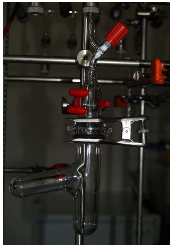
4. ábra: A karbonátos minták feltárására használt „két-ujjas” csapos vákuumozható mintatartó
