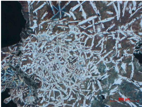
6. ábra: A 2. mintában látható cementit-perlites, finomszerkezetű globulit.
